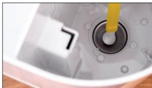
⚠ Pour le nettoyage de la membrane, n'utilisez en aucun cas d'objets pointus ni de produits de nettoyage agressifs ; cela pourrait endommager le BONECO U350 et annuler la garantie !
